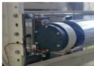
Sistemi di misura della tensione
