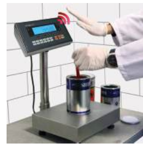
Operazione senza contatto Utilizzo senza contatto con sensori a infrarossi in condizioni gravose.
